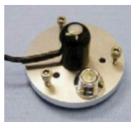
日射計 (オプション品) 波長範囲: 約300 ~1100nm 感度: 0.2\text{mV}/\text{Wm}^{-2} 精度: \pm 5\%
