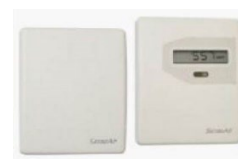
CO2測定機 (オプション品) 動作温度: 0 \sim 50^{\circ}\text{C} 動作湿度: 0 \sim 95\% 精度 \pm 30\text{ppm} DC24V
