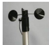
風速計 (オプション品) 起動風速: 0.4\text{m/s} 精度: \pm 0.25\text{m/s}
