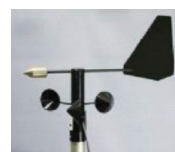
風向・風速計 (オプション品) 風向: 8方向表示 起動風速 0.54\text{m/s} 精度: \pm 0.45\text{m/s} 、 \pm 3^{\circ}
