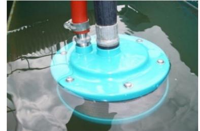
洗浄ガンのレバーを離すと、ストレーナー内側の回転ノズルから余水が強力に噴射され、給水フィルターに付着したゴミ・汚れを飛ばす構造になっていますので、現場での給水トラブルが激減します。
