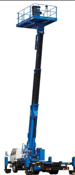
スーパーデッキシリーズ = TZS RR (リバース(後方格納)・ローラージャッキ)
