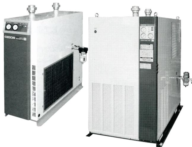
**特長** エアークンプレッサーからの湿気を含んだ圧縮空気を急激に冷却し、空気中の油と水蒸気を凝固させ取り除いた後に、熱交換機で加熱することにより配管内の結露を防止し、乾燥した空気を供給します。
