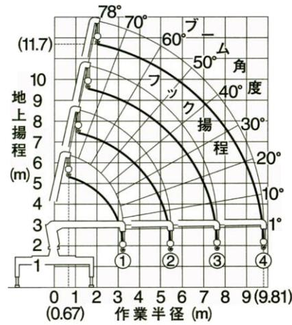
空車時定格総荷重表 (t) フック質量30kg含む ★アウトリガ最大張出し時 後方・側方吊り
