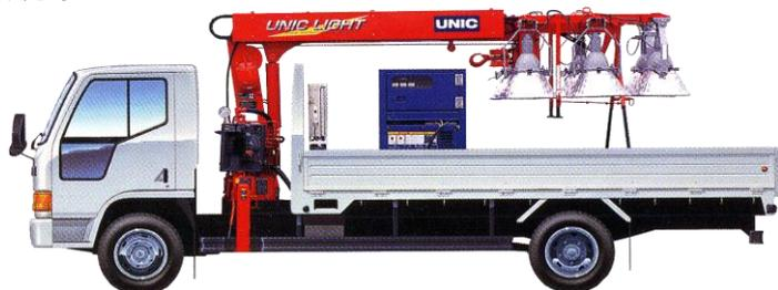
← クレーン付2tトラックのクレーン部に投光装置を取り付けた6灯式照明車
