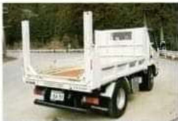
● 頑丈な補強荷台（新明和工業株式会社製） ● 強化炭素・林業用スタンプション
