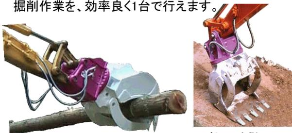
バケット内側にフォークを収納させた状態で溝掘り、床掘り等の掘削作業を行います。
